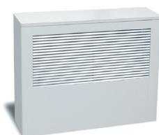
Il deumidificatore Dry 270 da incasso è una macchina a ciclo frigorifero concepita come componente degli impianti radianti residenziali che utilizzano acqua refrigerata a temperature comprese tra 15°C e 20°C per raffrescare gli ambienti. Il Dry 270 permette di abbattere l'umidità in eccesso presente nell'aria in ambiente contribuendo in maniera significativa all'ottenimento del comfort abitativo ottimale mantenendole a valori compresi tra il 50-65%.
